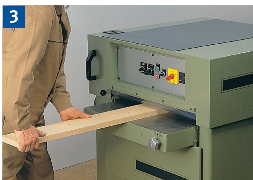
Hobeln breiter Werkstücke. Durch mehrere Hobelvorgänge das Endmaß herstellen.
