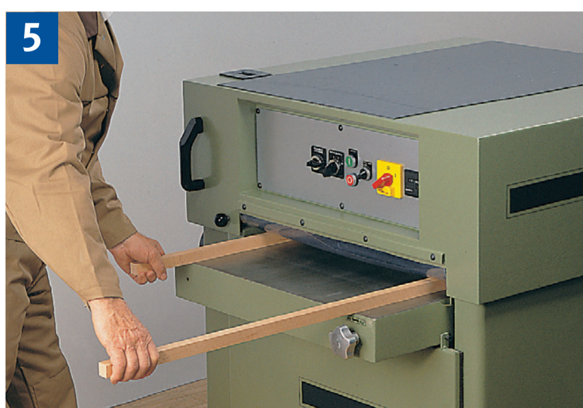
Hobeln schmaler Werkstücke. Bei starren Einzugswalzen und Druckbalken maximal zwei Werkstücke gleichzeitig bearbeiten.
