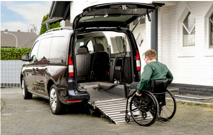
Mithilfe der eingebauten Rampe kann Lukas eigenständig ins Auto fahren.
