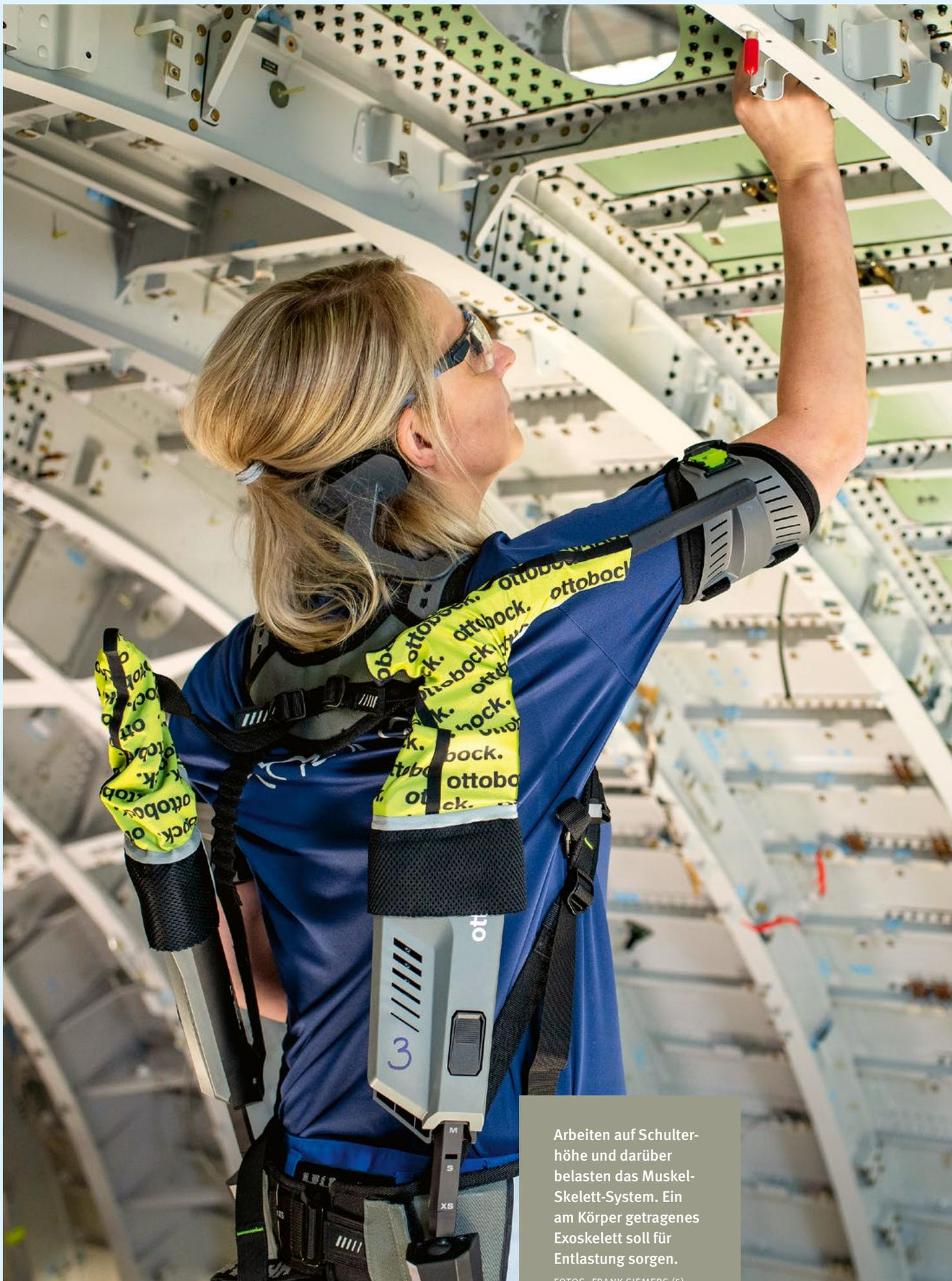
Arbeiten auf Schulterhöhe und darüber belasten das Muskel-Skelett-System. Ein am Körper getragenes Exoskelett soll für Entlastung sorgen.
