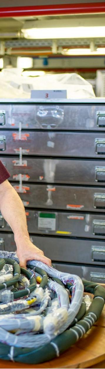
der Plastikfolie geholt, entrollt und von überflüssigem Tapeband befreit werden. Die Bündel können bis zu 80 Kilogramm wiegen. Um sie nicht mit Muskelkraft auf die Arbeitsplatte heben zu müssen, haben Torsten Hanisch und seine Kolleginnen und Kollegen einen Hubwagen bekommen. Als weitere Hilfe beim Entrollen der Bündel dient ein Tisch mit Drehplatte. „Eine Eigenkonstruktion, die auf Ideen unserer Mitarbeitenden basiert“, erläutert Christian Boehm.
