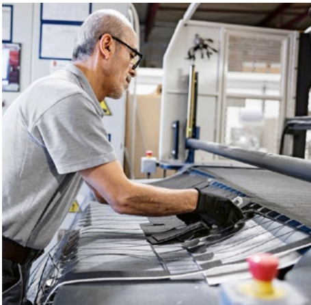
Viel Handarbeit: Mehrere Tausend Hitzeschutztaschen produziert der Betrieb täglich. Die Fertigung besteht aus mehreren Schritten, wie dem Stanzen.
