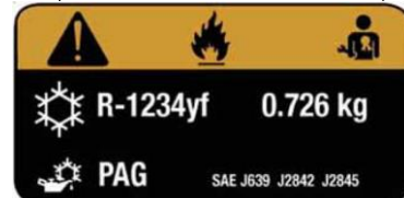
Beispiel Hinweisschild in einem Kfz mit R1234yf
