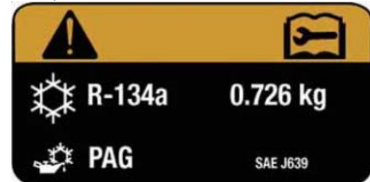
Beispiel Hinweisschild in einem Kfz mit R134a
