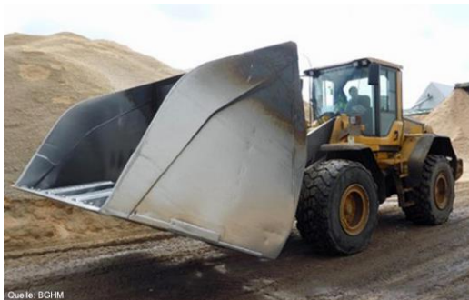
Radlader mit Leichtgutschaufel für 15 m³ Späne
