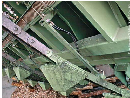
Zentralschmierung am rücklaufenden Kettenstrang eines Vereinzelners
