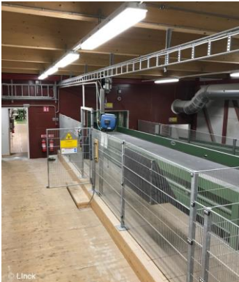
Messplatz mit Gefahrenbereichsicherung und geöffneter Zugangstür
